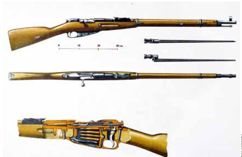
ВИНТОВКА МОСИНА 7,62-ММ ОБРАЗЦА 1891/1930 ГОДОВ. РЕПРОДУКЦИЯ ИЛЛЮСТРАЦИИ ИЗ КНИГИ «ОРУЖИЕ ПОБЕДЫ» ИЗДАТЕЛЬСТВА «МОЛОДАЯ ГВАРДИЯ», 1975 ГОД
